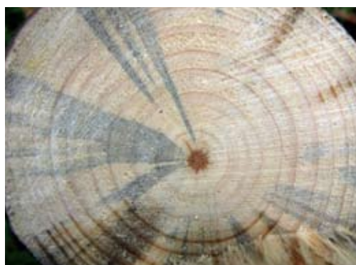
Przekrój poprzeczny przez drewno sosny – widoczne przebarwienia sinizny (ZS)
