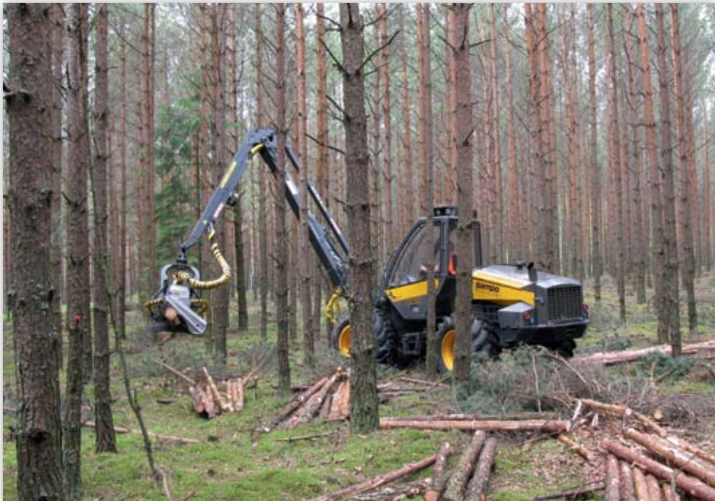
Harvester – taka maszyna w lesie tylko pozornie może budzić grozę, w rzeczywistości jest bardzo zwinna i znacznie przyspiesza proces wycinania określonych drzew (ZS)
